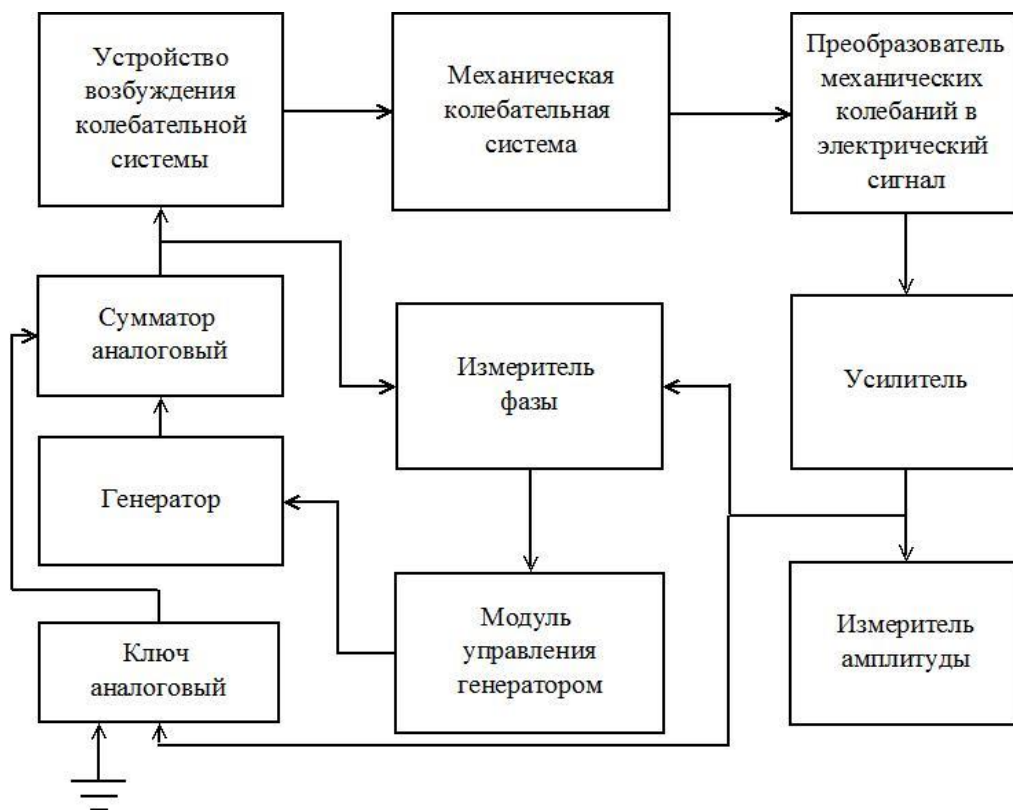
Рис. 1. Функциональная схема работы КС в режиме вынужденных колебаний с поддержанием заданного значения разности фаз путем подстройки частоты
