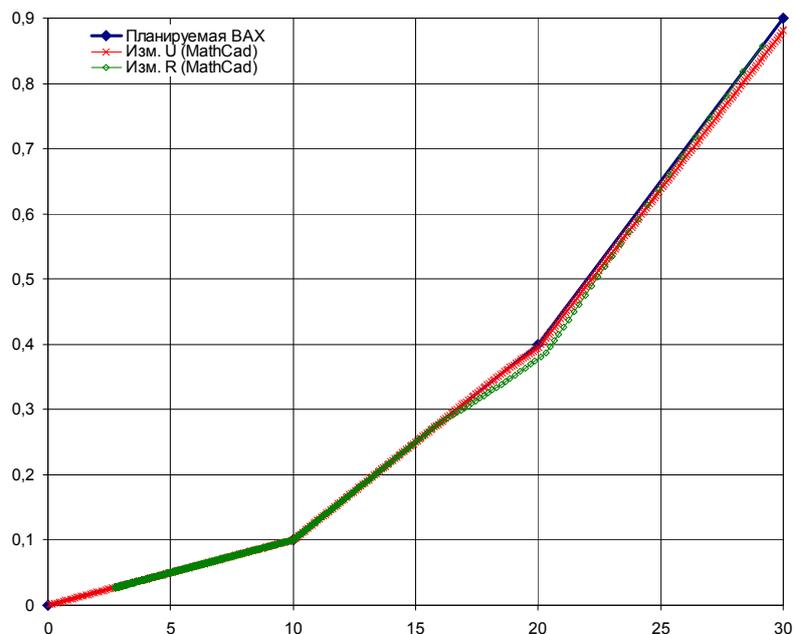
Рис. 2. ВАХ нелинейного элемента (рис. 1): планируемая и рассчитанная согласно (10) – (13) при изменении напряжения или сопротивления
