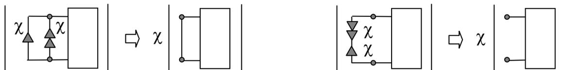
Рис. 4. Образование короткозамкнутых и разомкнутых ветвей с выделением параметров
