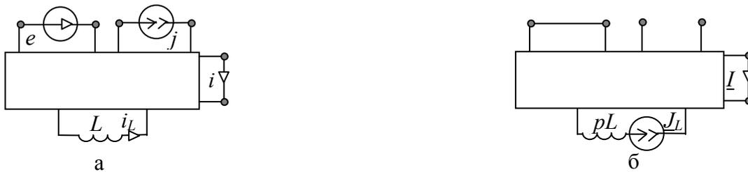
Рис. 2. Исходная схема (а); схема для построения коэффициента связи постоянных интегрирования токов  $I$  и  $J_L$  (б)
