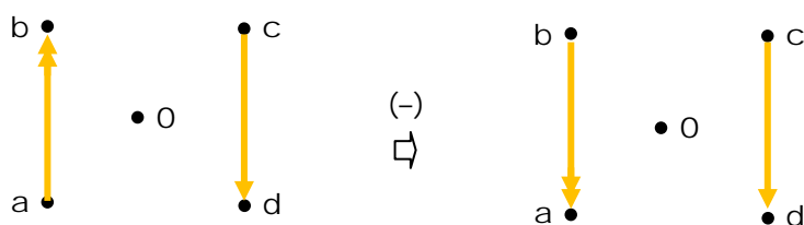
Рис. 4.3.2. Изменение знака схемного определителя при изменении направления норатора
